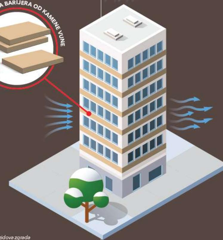
Vlaknasta struktura mineralnih vuna omogućava da višak vodene pare iz prostorija izade van, sprečavajući pojavu vlage i budi i tako štiteći zdravlje stanara i konstrukciju zgrade.
